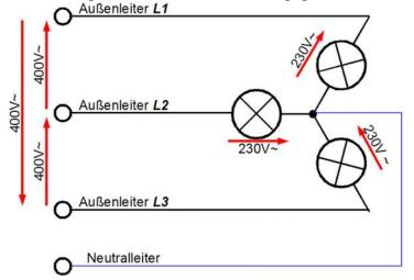
gegenüber dem Nullleiter die Effektivspannung von 230V.
