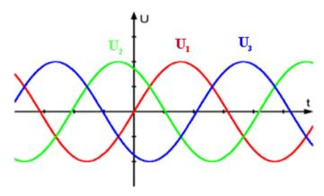
Die drei Rückleitungen der Phasenleitungen werden zu einer einzigen Leitung, dem Nulleiter, zusammengefasst. Im Falle einer gleichmäßigen Belastung aller Außenleiter ist der Strom im Nulleiter exakt Null.
